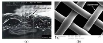
الشكل 9. صورة توضح SEM للنسيج مع ألياف النحاس (a) و PETEX (b).
