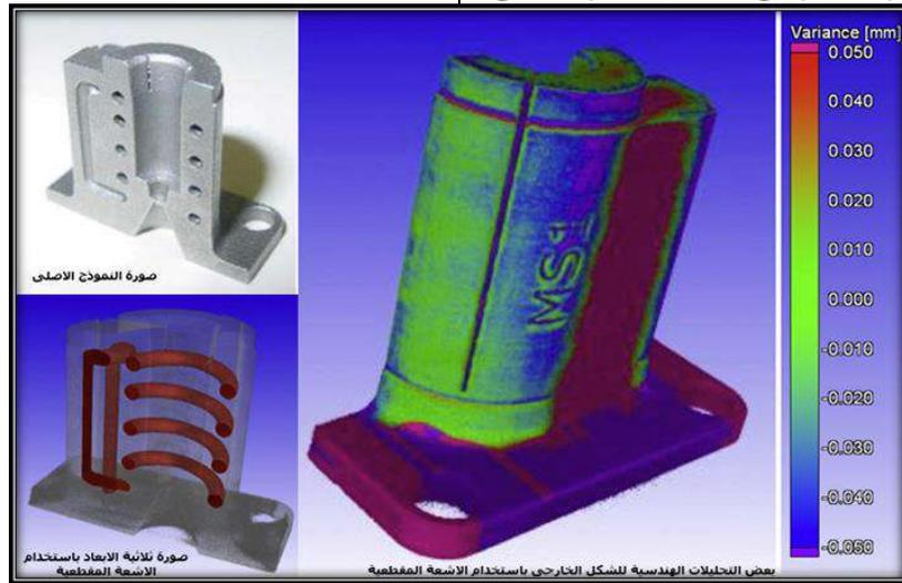
شكل(9) تحديد التجاويف الداخلية وتحليل للمادة المستخدمة باستخدام الأشعة المقطعية الصناعية (Noel, 2008)
