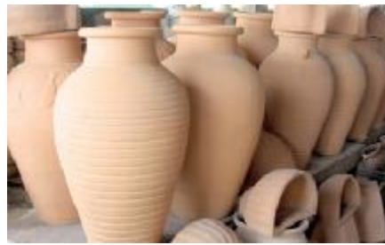
شكل (٣) تشكيل خزف بسكوت بعد الحرق الاول
