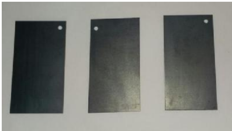
شكل رقم ( ٨ ) العينات بعد اجراء عملية الفسفتة
