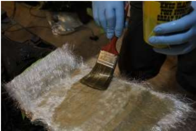
شكل (8) يتم دهان الالياف الزجاجية بالبوليستر بالفرشاة وتكرر العملية حتى السمك المطلوب.
