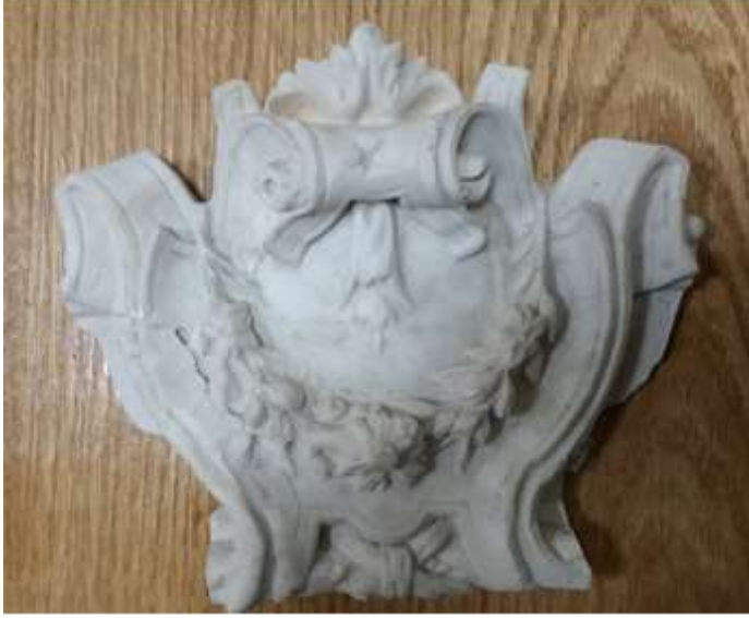
شكل (10) حلية من البوليستر بتأثير الرخام الطبيعي
