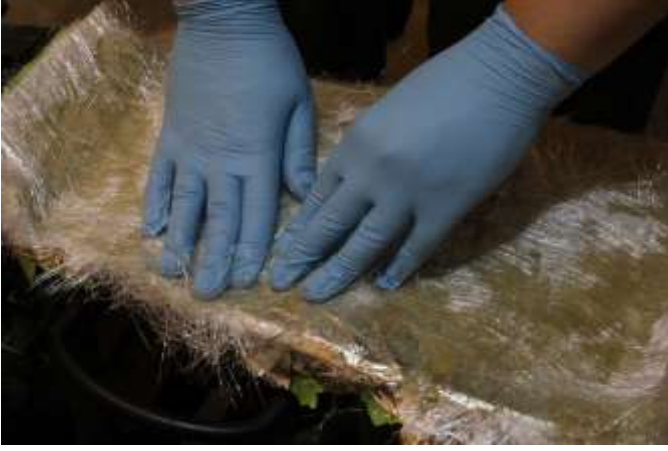
شكل (7) تثبيت الالياف الزجاجية في القالب بالضغط عليها وفردها في القالب.
