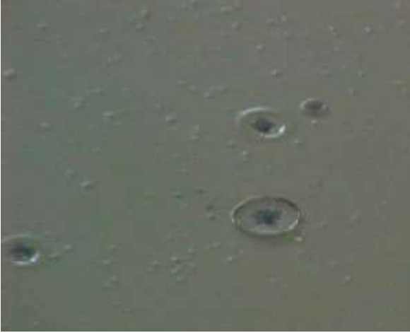
شكل (14) الثقوب في البوليستر نتيجة دخول الهواء أثناء الخلط
