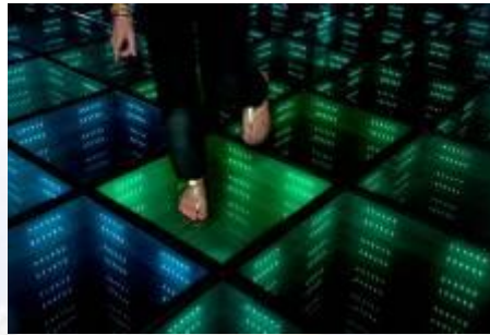
صورة (١٠) توضح أرضية رقص تفاعلية تولد الطاقة عند الرقص عليها، و تحول الأرضية إلي أرضية مضيئة من خبثات أرجل الراقصين عليها. (١٩)
