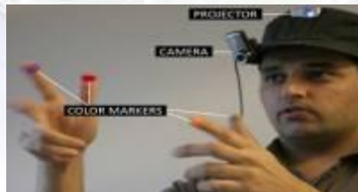
شكل (٦) يوضح مكونات معدات تكنولوجيا الحاسة السادسة (٨- ص ٦٨٦)
