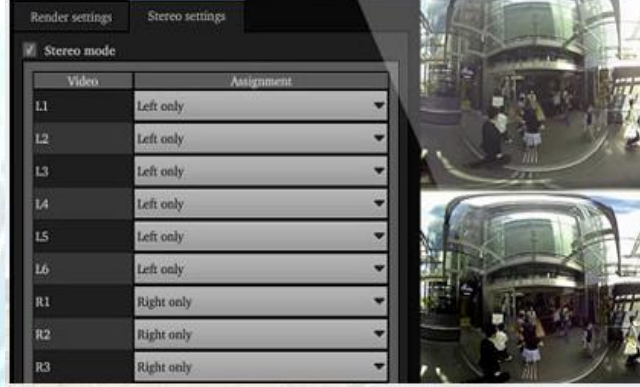
الشكل رقم (٢٦) شكل يوضح برنامج اوتوبانو فيديو اثناء عمل تجميع لفيديو من أكثر من كاميرا لانتاج فيديو واحد
