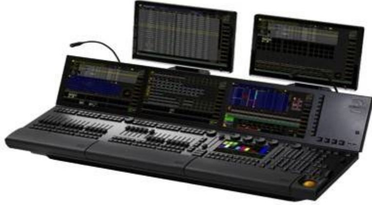
شكل رقم ( ٢٦ ) جهاز تحكم كنترول إضاءة DMX Console Lighting Grand MA
