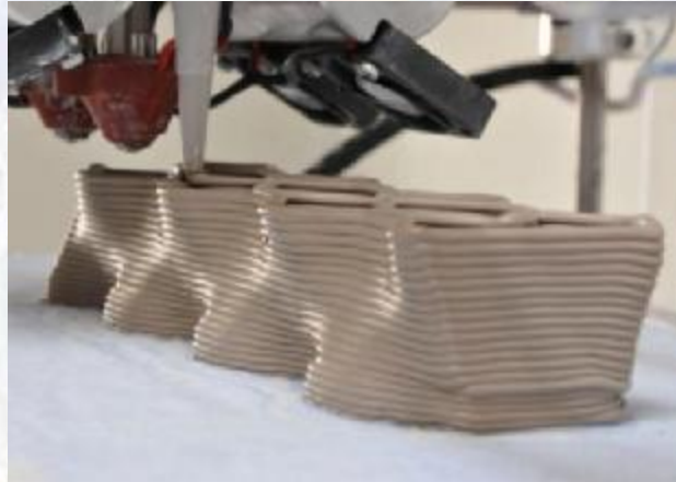
شكل (١٠) يوضح آلية عمل الطباعة الخزفية ثلاثية الأبعاد
