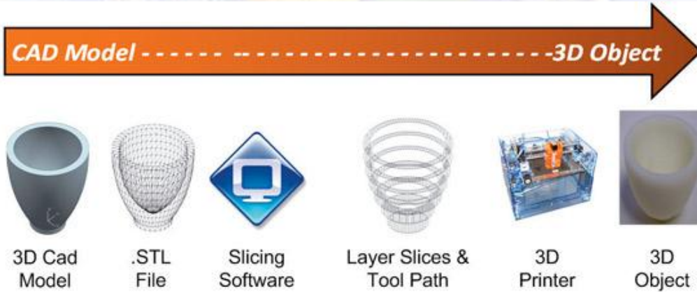
شكل (١) توضيحي يظهر عمليات ومراحل الحصول على نموذج ثلاثي الأبعاد
