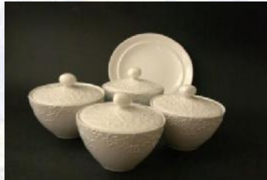
شكل (١٧) صورة المنتج النهائي للأنية المصممة وشكلت بطابعة ثلاثية الأبعاد وانضجت بالحريق
