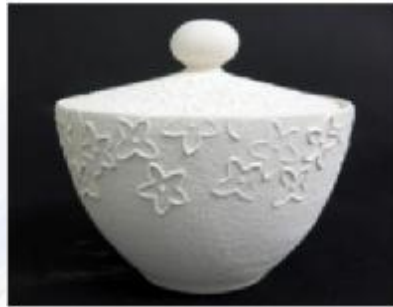
شكل (١٦) صورة للمنتج الخزفي بعد تشكيله بالطابعة ثلاثية الأبعاد وقبل عملية الحريق
