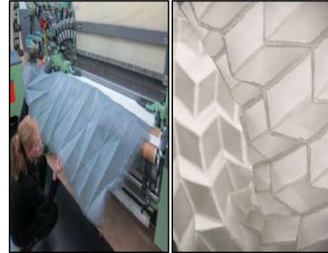
شكل (١١) يوضح النسيج ذو ذاكرة المركبة يعمل كقاطوع بأحد المحلات التجارية وموضح طريقة تصنيع النسيج ذو الذاكرة المركبة (٧)
