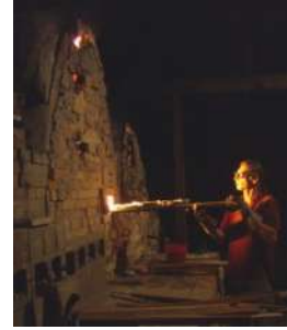
شكل (١) فرن خاص بحريق الطلاءات الملحية فقط
