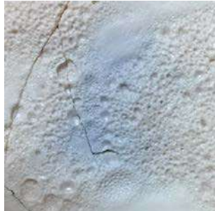
شكل (١-٢) تطبيق ملح كلوريد صوديوم جاف على سطح البلاطة ثم الحريق في الفرن النفقي، ظهرت تأثيرات على السطح عبارة عن تآكل في سطح البلاطة فظهرت كأنها ملامس عميقة متنوعه كالتنقيط أو البثور العميقة والبسيطة المتنوعة في الحجم، و الجسم حدث له طلاء خفيف جدا أو طلاء ذاتي self-glaze .
