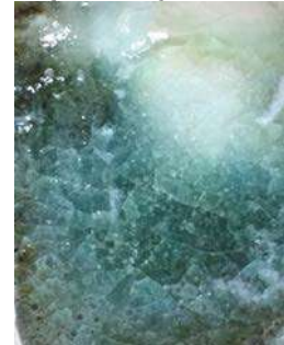
شكل (١-ج) بلاطة من البورسلين وضع عليها الملح داخل العلية الحرارية ونجد أن بها تأثيرات ملونه بالرغم من انها كانت غير ملونه ونجد البلورات ظاهرة في الطلاء بشكل واضح وكذلك التشققات الواضحة في سطح الطلاء .
