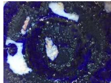
شكل (١٢-ب) نلاحظ تأثير التآكل والفوران مع ظهور لون الجسم الأبيض في بعض المناطق، واختلاف درجات اللون الأزرق.
