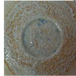
شكل (١٢-أ) نلاحظ تأثير التآكل والفوران الناتج عن كلوريد الصوديوم، مع لمعان أكثر نتيجة لوجود كربونات الصوديوم وحمض البوريك
