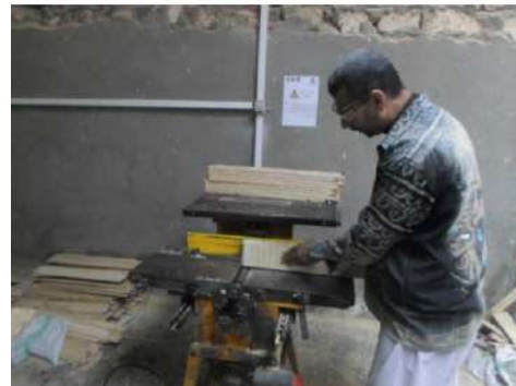
شكل (٨) أحد مراحل تصنيع ألواح خشب من سعف النخيل، يتم تجميع الأجزاء وتسويتها لإنتاج لوح كامل بمقاس ثابت
