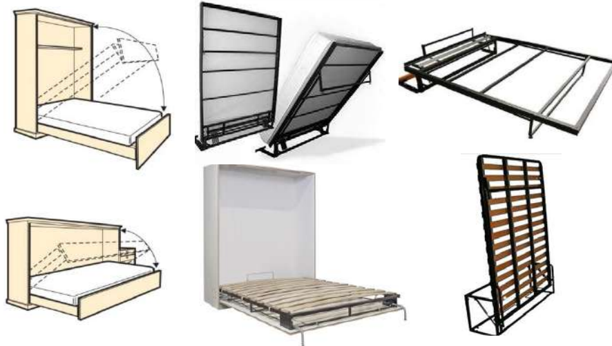
صورة (١١) توضح شكل الإطار المعدني الذي يثبت بال صندوق، بحيث يكون قابل للدوران والطي بزواوية ٩٠ درجة عند الإنغلاق
