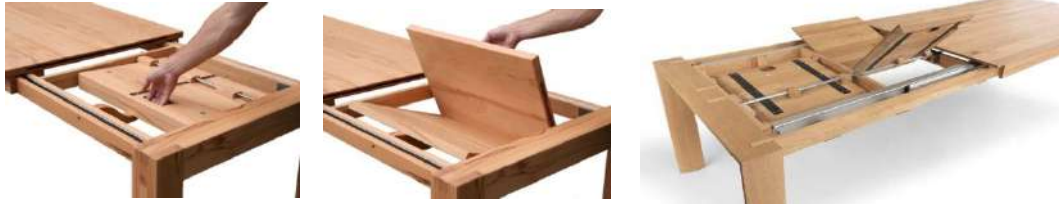
صورة (٥) توضح كيفية تشغيل أحد أنظمة الطاولات القابلة للتمدد، وذلك عن طريق سحب القرصة العلوية للطاولة بواسطة المجاري المعدنية المثبتة أسفلها، ثم رفع الأجزاء الخشبية التي تعمل على زيادة سطح الطاولة، والتي تكون مطوية أسفل القرصة
