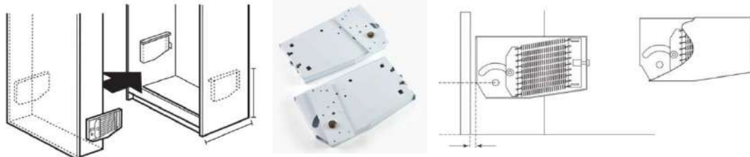
صورة (١٢) توضح شكل نظام اليايات أو السوست المستخدمة لتثبيت هيكل السرير المعدني في وحدة الصندوق الخاص به
