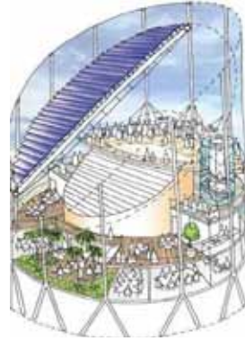
شكل (٨) كروكي منظور لسطح البرج و به وحدات خلايا شمسية لتوليد الطاقة.
