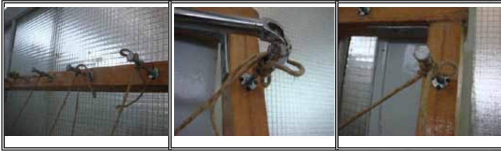
شكل (10) مسامير الكمنجة المثبتة بالإطار شكل (11) لف المسامير باستخدام مفتاح معدني شكل (12) أحبال شد الجلد علي المسامير المعدنية
