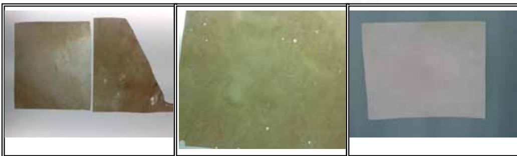
شكل (19) رق نقي بدون عيوب شكل (20) ثقب لحدوث شد زائد للرق شكل (21) عيوب في السمك بالحواف وثقوب
