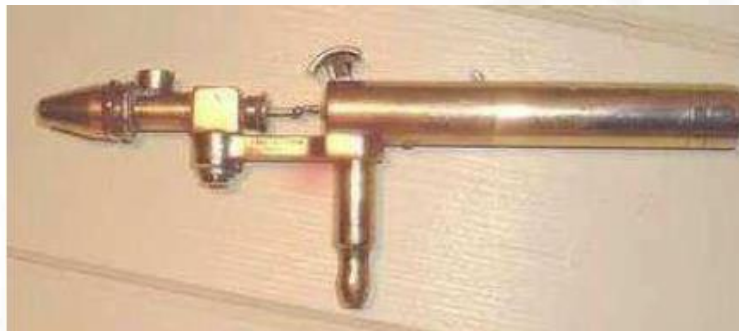
شكل 6: نموذج مبكر لأداة الإبربرش التي طورها تشارلز بورديك تحت اسم Aerograph
