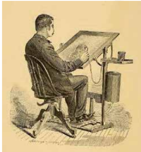
شكل 1: رسم منشور أواخر القرن التاسع عشر يظهر رجلا جالسا يقوم بتحريك بدالا لضخ الهواء إلى أداة إيربرش ميكرة
