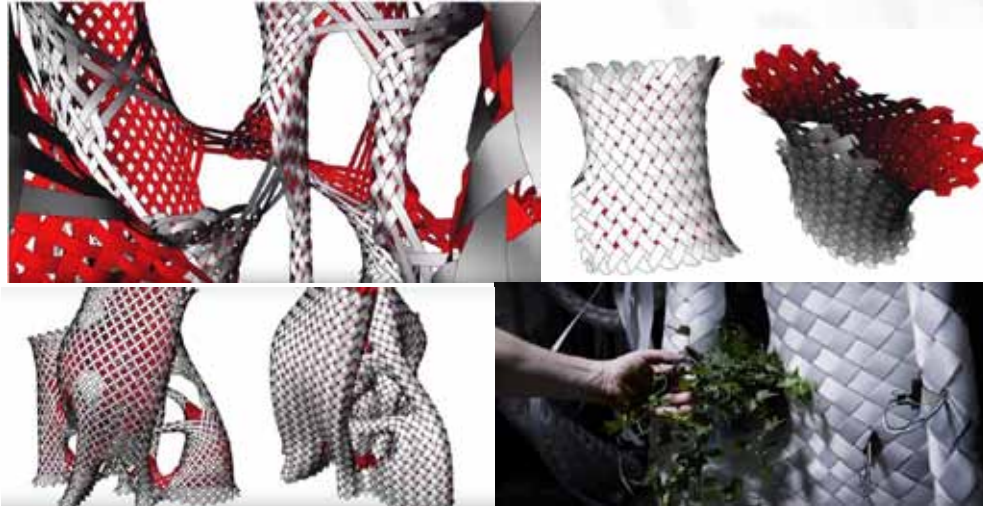
شكل رقم (٩) المجدولات وطرق ربطها لعمل بيئات نمو للنباتات تتسم بالمرونة تم تصنيعها من خلال تكنولوجيا الطباعة ثلاثية الأبعاد وذلك باستخدام الألياف الزجاجية
