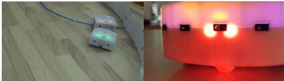
شكل رقم (٧) يظهر الروبوتات المستخدمة وكيفية استشعارها لبعضها البعض كذلك الإضاءة المدمجة بداخل تلك الروبوتات (١٧)
