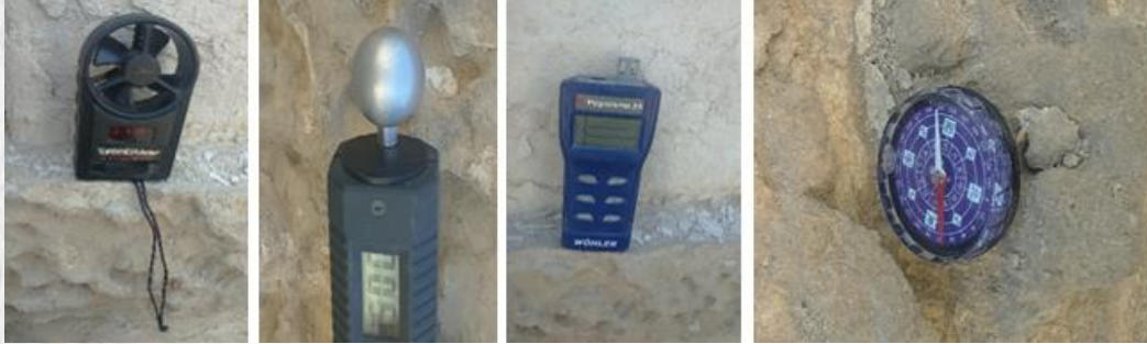
شكل رقم (2) يوضح بعض أجهزة القياس درجات الحرارة والرطوبة وسرعة الرياح التي استخدمت في الدراسة البيئية للقطاع 2000
