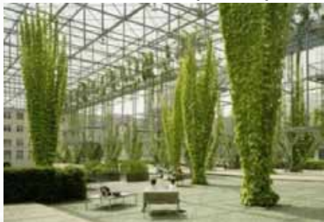
شكل (8) الحائط الأخضر بنظام النباتات المتسلقة على الكابلات - سويسرا
