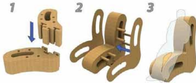
شكل رقم (10): تصميم مجموعة من قطع الأثاث باستخدام الورق المقوي قابل للفك والتركيب حيث جمع المصمم بين الورق المقوي المعاد استخدامه والمعاد تدويره
