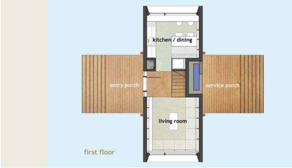
شكل (٢٥) المسقط الأفقي للدور الأول للمبنى يحتوى على غرفة معيشة و سلم لمنطقة المدخل و حيز خدمة و سلم داخلى للثانى و مطبخ و يظهر باللون الأزرق مكان توربين الرياح الدائرى .
