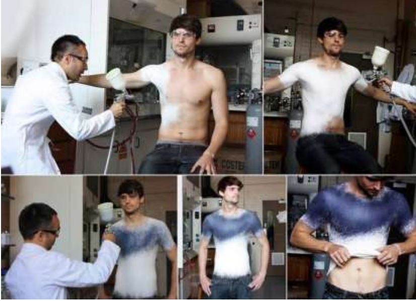
صورة رقم 4: الباحث مانيل توريس Manel Torres وهو يقوم برش الرذاذ الذي يتحول إلى نس يج مباشرة على الجسم
