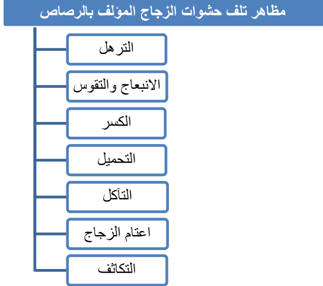
الشكل يوضح مظاهر تلف حشوات الزجاج المؤلف بالرصاص
