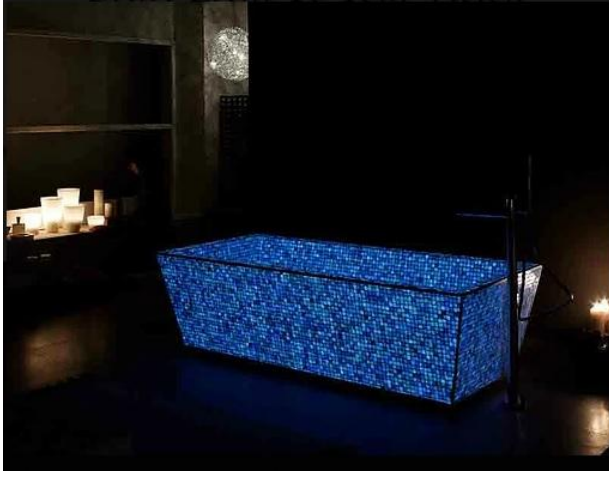
شكل (8 أ، ب): يوضح استخدام الصبغات الفوسفورية في البلاطات الزجاجية والمستخدمة كتنكسية لحوض إستحمام، وفي الشكل 8 أ يظهر الحوض في الإضاءة العادية والشكل 8ب في الظلام حيث يتوهج الحوض بدرجات من اللون الأزرق. 1
