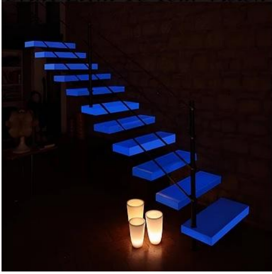
شكل (5 أ، ب): يوضح استخدام الصبغات الفوسفورية على السلالم الزجاجية حيث يظهر في الشكل 5أ السلم في الإضاءة الطبيعية وفي الشكل 5ب في الظلام حيث تتوهج درجات السلم باللون الأزرق. 1
