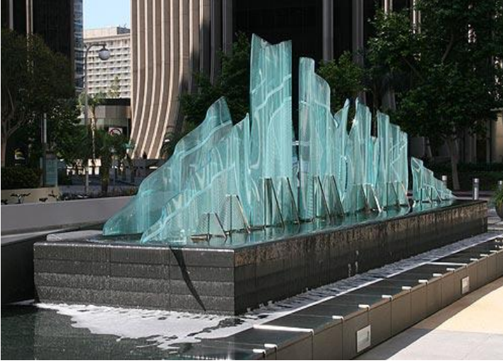
شكل (14): عبارة عن نافورة زجاجية تأخذ الشكل الهرمي وتتكون من مجموعة من الشرائح المنحنية المعاد تشكيلها حرارياً. 2
